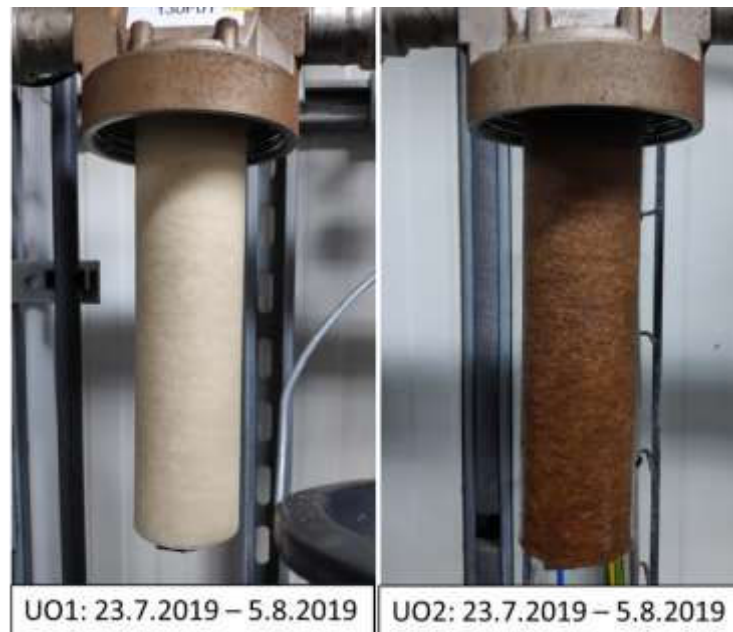
Abbildung 19: Filterkerze an UO1 (mit \text{NH}_2\text{Cl} ) und UO2 (ohne \text{NH}_2\text{Cl} ) im Vergleich
